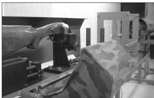
Рис. 4. Самодельное бесствольное оружие с патроном СП-4, закрепленное на установке «Скорость»
