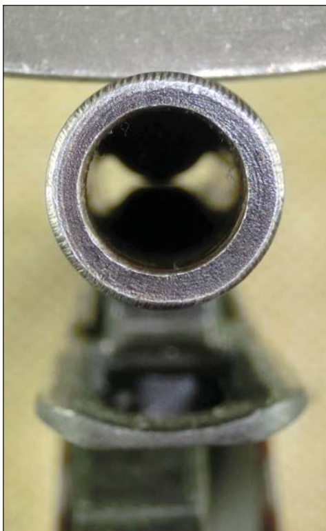
Рис. 4. Вид канала ствола пистолета MP-80-13T со стороны дульного среза ствола
