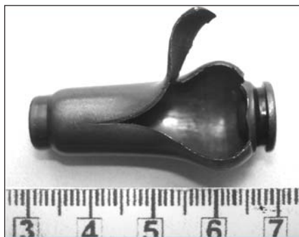
Рис. 3. Разрыв корпуса гильзы патрона СП-4 при выстреле без ствола с колодки ружья ИЖ-18Е 20-го калибра
