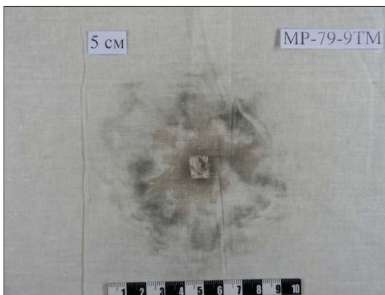
Рис. 6. Экспериментальная мишень. Повреждение, образованное при выстреле из пистолета MP-79-9TM с дистанции 5 см от дульного среза ствола пистолета до мишени
