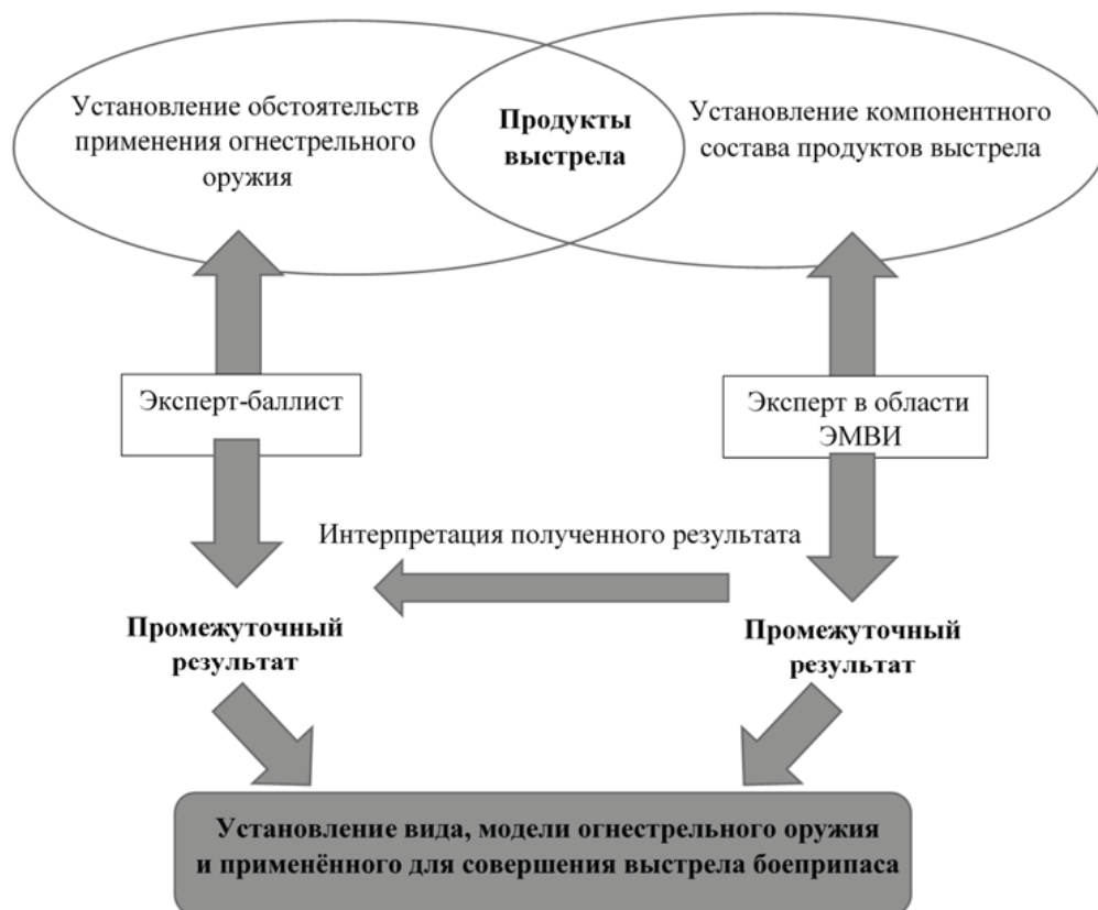
Рис. 2. Схема комплексного исследования продуктов выстрела экспертом-баллистом и экспертом в области ЭМВИ
