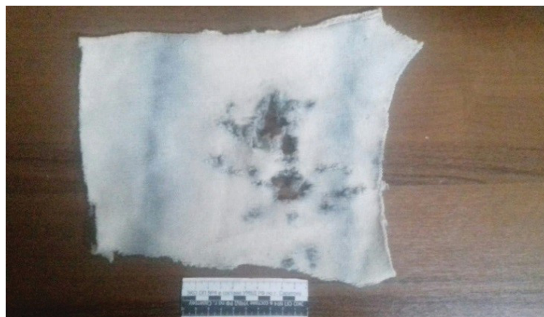
Рис. 3. Сквозное повреждение неправильной формы с рваными краями шерстяной ткани
