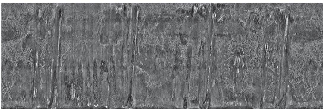
Рис. 4. Фоторазвертка ведущей поверхности выстреленной пули, подвергшейся термическому воздействию (температура 750 °С, время обжига 30 мин)
