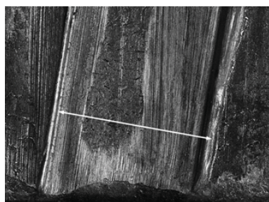
Рис. 2. Фрагмент вторичного следа на выстреленной пуле: а – общий вид вторичного следа (стрелкой отмечена ширина следа); б – нижняя часть вторичного следа с трассами, повернутыми на угол наклона поля нареза (увеличение порядка 70×)
