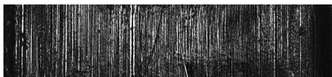
Рис. 2. Фрагмент вторичного следа на выстреленной пуле: а – общий вид вторичного следа (стрелкой отмечена ширина следа); б – нижняя часть вторичного следа с трассами, повернутыми на угол наклона поля нареза (увеличение порядка 70×)
